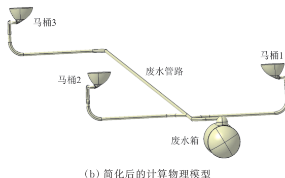
图 1 废水系统的物理和计算物理模型
