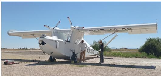
图3 Flyox Mark I 两栖无人机<sup>[12]</sup>
