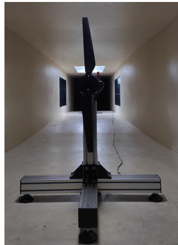
图10 风洞中的螺旋桨(直径0.61 m)
