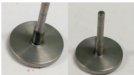
图 5 顶杆磨损痕迹
