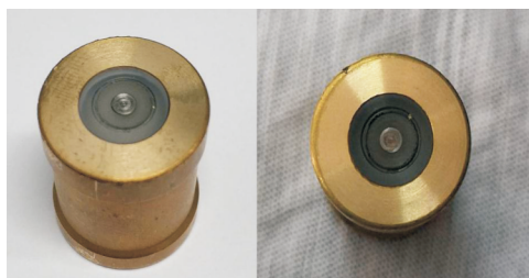
图 7 减压活门垫上的多余物
