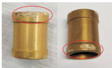
图 6 减压活门磨损情况
