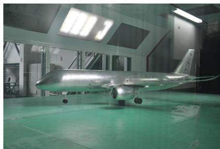
图1 系留气动力测量风洞试验
