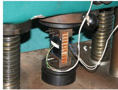
图6 侧压实物夹持图
