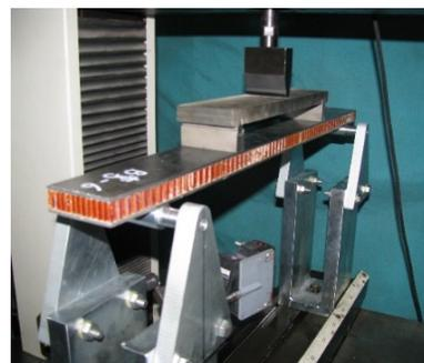
图 4 四点弯曲试验
