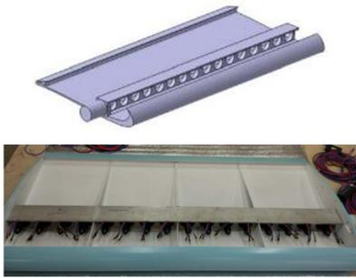
图5 内置气源(涵道风扇)方式<sup>[56]</sup>
