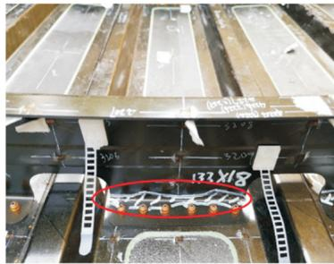
图 9 整体框无侧向支撑试验件外缘R区破坏
