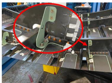
图 2 侧向支撑角片示意图
