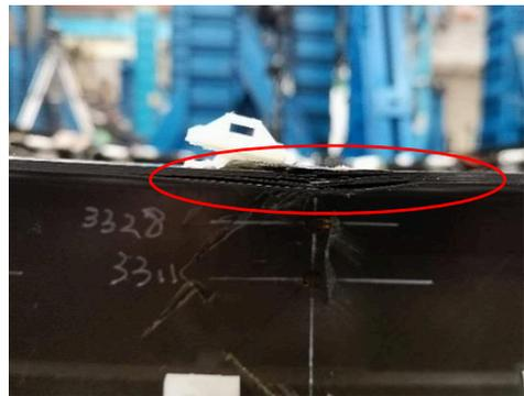
图 12 整体框内缘分层破坏
