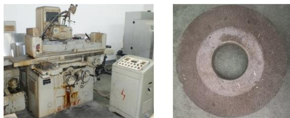
(a) MM7120A平面磨床 (b) SA80F13V砂轮
