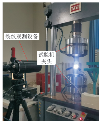
图 2 疲劳试验设备及实施方法
