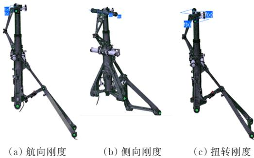
图 2 起落架刚度表征模型
