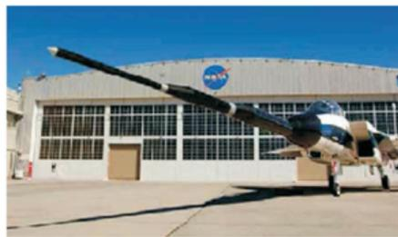
(a) 装有完全伸出的静音锥准备SMI试验的NASA F-15B#836
