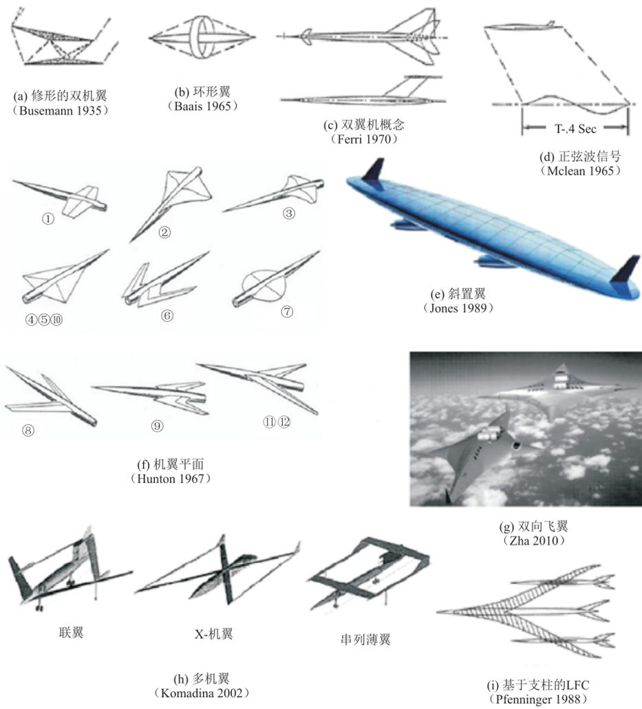
图 11 探索过的一些具有抑制声爆作用的飞机布局<sup>[1,11]</sup>
