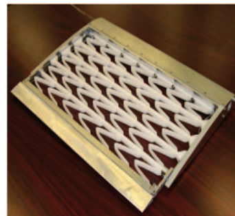
图 20 基于蜂窝结构的变弦长翼 [30]
