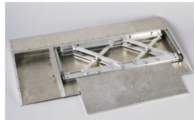
图 19 基于桁架结构的变弦长翼 [29]
