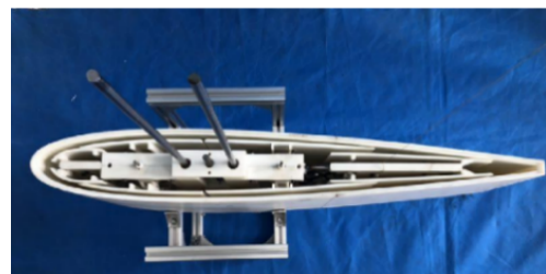
图 9 具有连续表面的伸缩式变形翼 [13]
