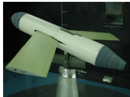
图10 采用气动机构的变后掠翼 [17]
