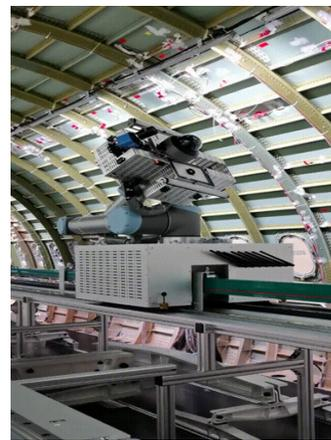
图5 试验损伤自动化巡检系统应用展示
