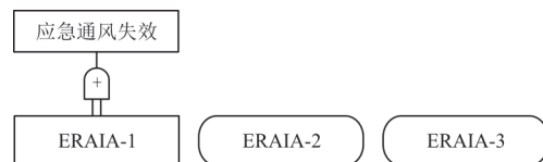
(b) 应急冲压空气作动器故障逻辑
