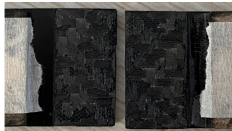
图 8 0.2 mm 时拉伸断裂 Fig. 8 Tensile fracture at 0.2 mm
