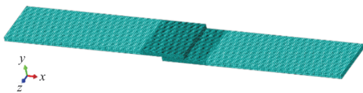
图 12 胶接结构有限元模型
