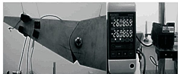
图 6 后缘偏转驱动承载实验 [12] Fig. 6 Trailing edge deflection drive load test [12]
