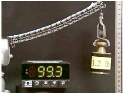
图 3 SMA 驱动器负载测试 [8] Fig. 3 SMA actuator load test [8]
