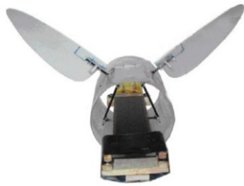
图 14 使用 LIPCA 驱动的扑动装置 [23] Fig. 14 Flapping device using LIPCA driver [23]
