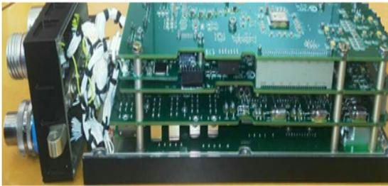
图 2 电子程控器组成示意图
