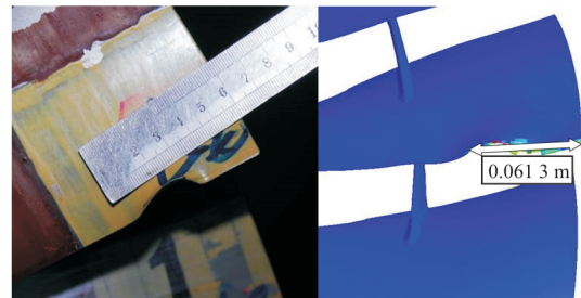
(a) 2号叶片变形情况的试验与数值模拟结果 ( t=0.6\ \text{ms} )
