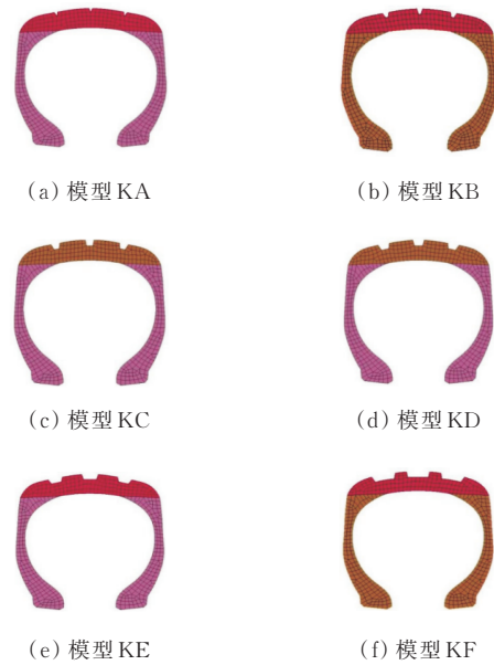
图 17 不同沟槽宽度轮胎构型 Fig. 17 Different groove width of tire configuration
