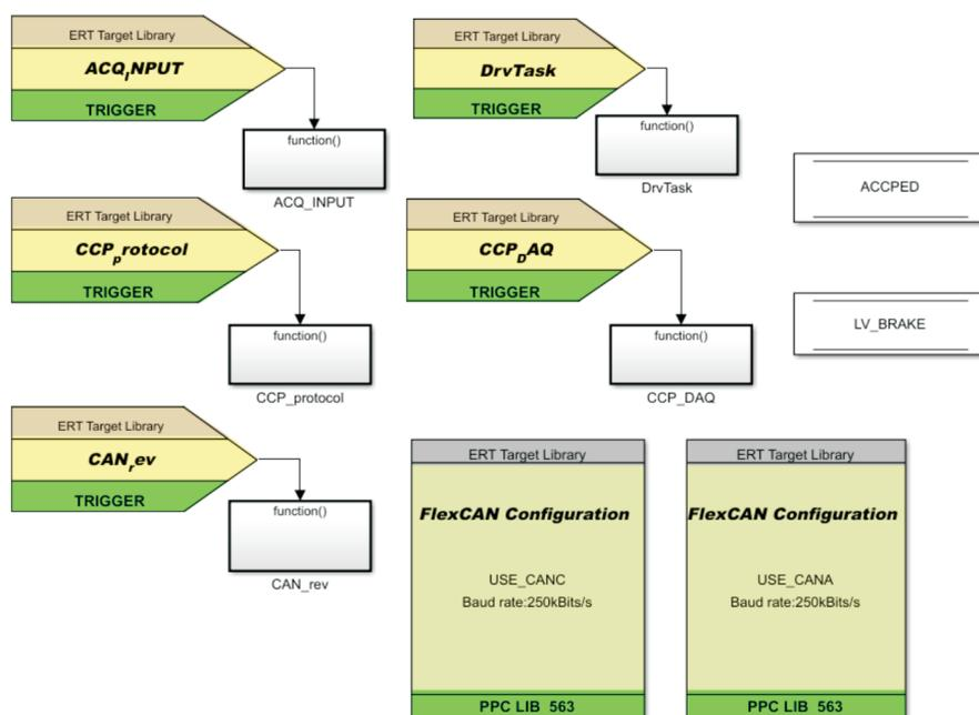
图 6 M2C 控制器开发平台子模块
