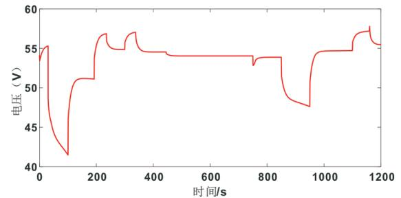
图 12 锂电池电压变化
