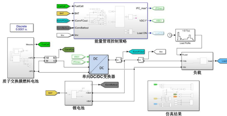
图 5 燃料电池混合动力系统仿真模型
