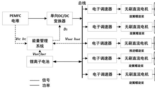
图2 燃料电池混合动力系统构型图
