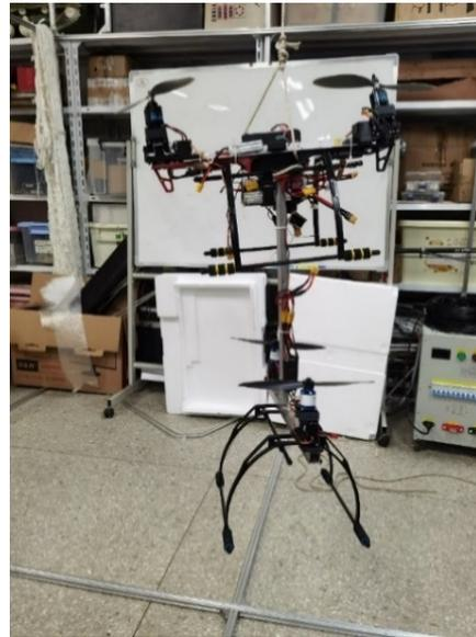
图 9 两机组拼飞行器实物图
