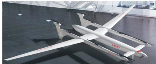
(b) 连翼飞机示例2<sup>[36]</sup>
