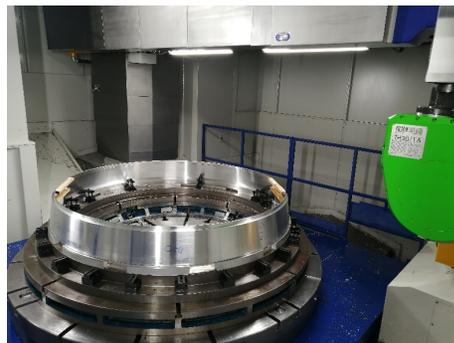
图 19 精车后的零件
