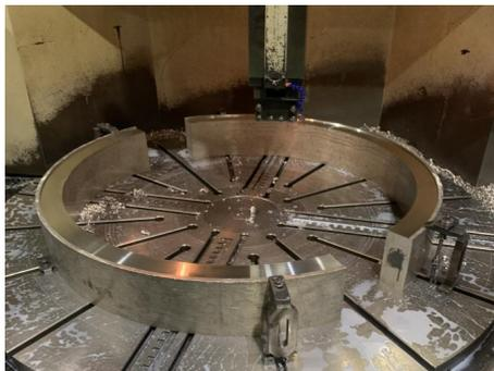
图5 切削试验后承力框零件图
