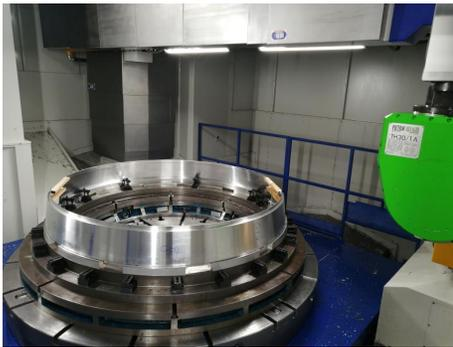
图 11 精车后的零件
