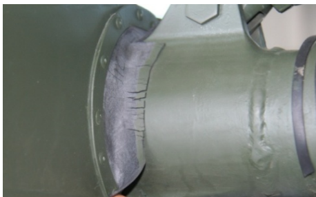
图12 密封橡胶龟裂 Fig. 12 Sealing rubber crack
