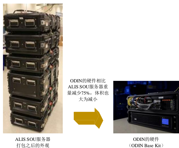
图9 升级后的ODIN硬件与ALIS SOU服务器的对比
