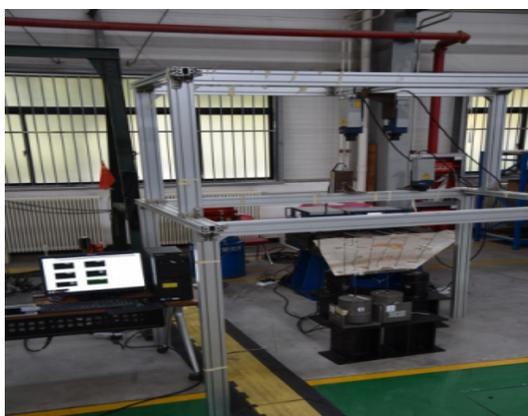
(a) 舵面风洞模型地面颤振试验现场
