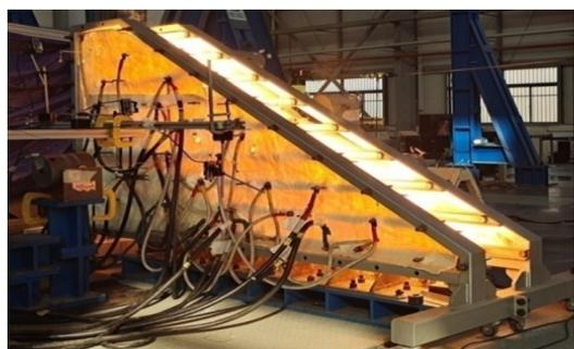
(c) 翼板地面热颤振试验现场
