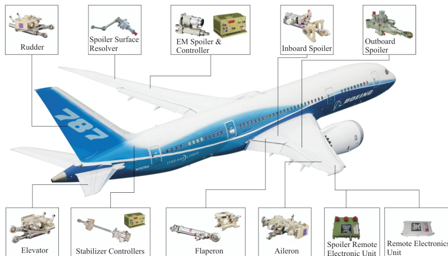
图 3 带有远程监控模块的 B787 飞控系统机载设备
